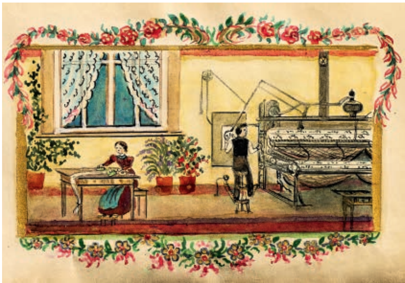
Der Mann bedient die schwere Handstickmaschine (Pantograf), die Frau fädelt Nadeln ein. Aquarell von Babeli Giezendanner, Eintrag von 1895.
